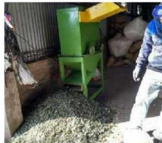
lla. Tiene un motor de 3HP trifásico que se sacó de una máquina de moler ladrillo que estaba en desuso. La máquina tiene dos ejes con unas paletas que se cruzan en una rejilla y allí caen las botellas y el vidrio molido cae a una noria donde se zarandea. Se pueden moler hasta 10 botellas por vez y todo el día" indicaron desde el Municipio.
